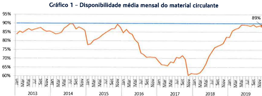
A fiabilidade do material circulante reflete a inflexão da linha de decrescimento, ocorrido desde Maio de 2016, evidente demonstração do esforço desenvolvido ao longo de todo o ano de 2019 de recuperação das condições de manutenção e de funcionamento do material circulante.
